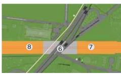
4 La partie de la tranchée couverte devant passer sous la chaussée de La Hulpe s'achève par cette 3eme phase. Les bandes de circulation ainsi que les rails du tram retrouveront leur emplacement initial 6. Les travaux continueront, ensuite, par la réalisation de la tranchée couverte en direction du clos des Chênes 7 et en direction de la rue des Archives 8.
