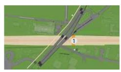
Afin de garantir la circulation routière, piétonne et du tram à hauteur de la chaussée de La Hulpe durant les travaux, la tranchée couverte sera réalisée en plusieurs phases. Durant la première phase des travaux, les parois latérales et la dalle de couverture de la future tranchée couverte (1) seront réalisées au sud de la chaussée de La Hulpe (côté clos des Chênes). Cette nouvelle structure permettra d'y basculer le trafic vers Auderghem.
