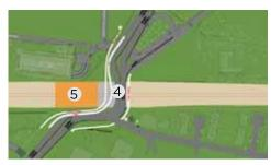
3 La troisième phase débute donc par la déviation de la bande de circulation en direction d'Ixelles et de la ligne de tram 4. L'espace ainsi libéré permettra de réaliser les parois latérales et la dalle de couverture de la future tranchée couverte au nord de la chaussée de La Hulpe 5 (côté rue des Archives).
