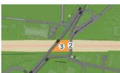
2 Une fois la bande de circulation vers Auderghem déviée 2, les parois latérales et la dalle de couverture de la future tranchée couverte pourront être aménagées au centre de la chaussée de La Hulpe 3. Cette structure permettra d'y dévier par la suite la voirie en direction d'Ixelles ainsi que la ligne de tram.
